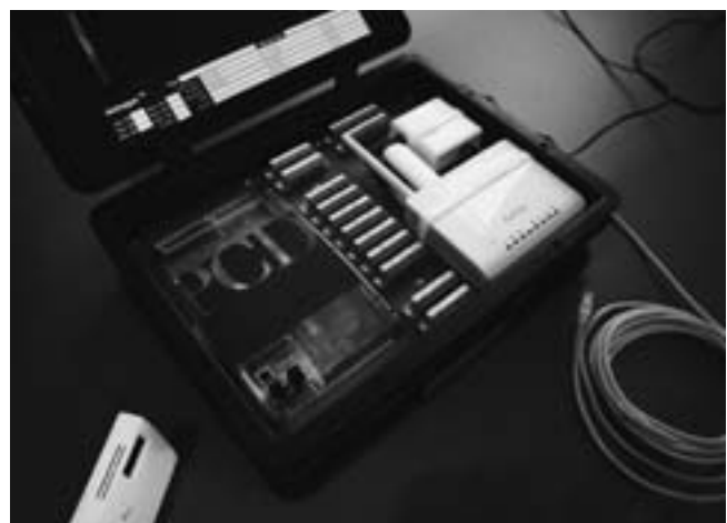
Datenlogger und Steuerung mit Fernzugriff über Internet (Foto: Huber Energietechnik AG, Zürich).
