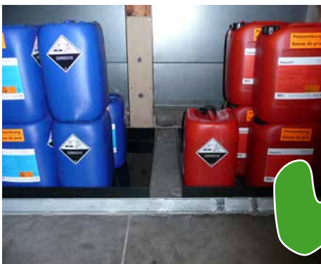
Bei unkontrolliertem Auslaufen können Säuren und Laugen in gefährlicher Weise miteinander reagieren. Alle Gebinde die nicht dem täglichen Bedarf dienen, sind getrennt in Auffangwannen zu lagern.
