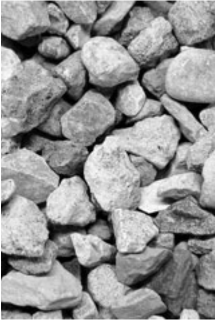
Rückbaustoffe (Recyclinggranulat) können anstatt Kies zur Herstellung von Beton verwendet werden.
